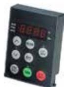
Il kit di comando per per aspiratori centrifughi si compone di un inverter per la regolazione della velocità di rotazione del ventilatore, e di un tastierino remoto (collegato via cavo) che opzionalmente ne consente il controllo a distanza.
