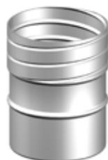
Il giunto mono-Starflex, con l'uso di sigillanti antifiamma o siliconi idonei alle alte temperature, garantisce un'ottima tenuta alle pressioni e mediante la filettatura si ottiene una giunzione antisfilamento. Il collegamento monoparete maschio si trova situato nella parte inferiore, mentre il flessibile va collegato nella parte superiore. Il tutto conferisce al sistema le caratteristiche di tenuta previste dalle normative vigenti.
