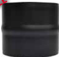
Prodotto in grado di unire due tubi con lato femmina. Presenta due estremità rastremate a formare l'innesto maschio. Serve inoltre per invertire il senso dei fumi prodotti da generatori di calore funzionanti a combustibile solido, in pressione negativa e temperature di utilizzo massime fino a 600°C.
