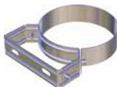
È l'accessorio che serve per fissare ad una parete in modo veloce, pratico, sicuro e preciso, una canna fumaria distanzian-dola di 50 mm dalla parete stessa, mantenendola in posizione assolutamente verticale. Per garantire un fissaggio sicuro, deve essere installata almeno ogni 3 metri.
