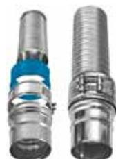
Il supergiunto Flexkit è uno speciale raccordo che permette di unire meccanicamente il tubo flessibile doppiaparete interna liscia Starflex a qualsiasi elemento o modulo della serie Eurostar monoparete, consentendo una resistenza alle pressioni fino a 1000 Pascal senza impiego di silicone (test TUV A 1038E-00/02).
