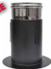
Dispositivo che permette di passare dal sistema in ferro ai sistemi in acciaio INOX dando la possibilità di effettuare una regolazione in lunghezza attraverso un modulo telescopico. È provvisto di rosone maggiorato con tre fori da 5 mm per il fissaggio a parete/soffitto mediante tasselli ad espansione.
