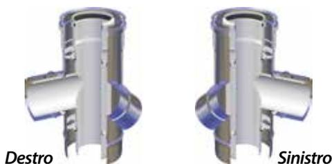
Il raccordo a "T" 87° sdoppiato consente di collegare il canale da fumo alla canna fumaria con un angolo di 87°. Questo elemento ha la peculiarità di dividere l'aria comburente dall'espulsione dei fumi nel canale da fumo. La derivazione dell'aria comburente può essere estrusa a destra o a sinistra del corpo del camino.
