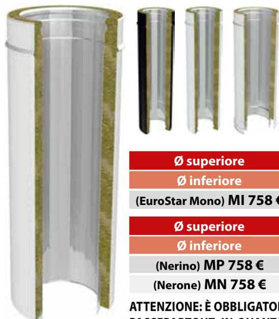
Questo elemento serve per raccordare il canale da fumo ai vari sistemi G<sub>ZeRo</sub> Passepartout "Solai" e G<sub>ZeRo</sub> Passepartout "Supporto a tetto". Si tratta di un elemento lineare da 500 mm, coibentato con una speciale lana di roccia, a bassissimo contenuto di resina, che ne garantisce la stabilità nel tempo.
