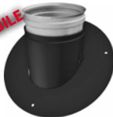
Dispositivo che permette di passare dal sistema in ferro ai sistemi in acciaio inox. È provvisto di rosone maggiorato con tre fori da 5 mm per il fissaggio mediante tre tasselli ad espansione. Può essere montato su superfici inclinate in quanto il rosone può ruotare in funzione della pendenza della superficie di fissaggio.
