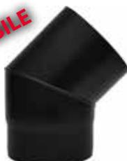
Dispositivo che permette di deviare l'asse o di eseguire spostamenti del canale da fumo di 45°, per l'evacuazione fumi prodotti da generatori di calore funzionanti a combustibile solido, in pressione negativa e temperature di utilizzo massime fino a 600°C.
