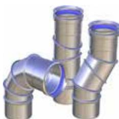
Diese Bögen ermöglichen die Verschiebung oder Neigung der Rauchgasachse bzw. des Rauchkanals. Die einzelnen Elemente können um 360° gedreht werden, wodurch die Möglichkeit besteht, sich an jeden Neigungswinkel anzupassen und die Dichtheit des Systems gegenüber den Drücken sicherzustellen.
