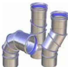
Diese Bögen ermöglichen Verschiebungen oder Neigungen der Rauchgas- oder Rauchkanalachse für den Einsatz mit Biomasse-Wärmeerzeugern, bei Abgastemperaturen von bis zu 600 °C, wobei sie auch Rußfeuer widerstehen. Die einzelnen Elemente sind um 360° frei drehbar und können sich jedem Neigungswinkel anpassen. **Sie können nur in Systemen im Unterdruckbetrieb verwendet werden (N1).**
