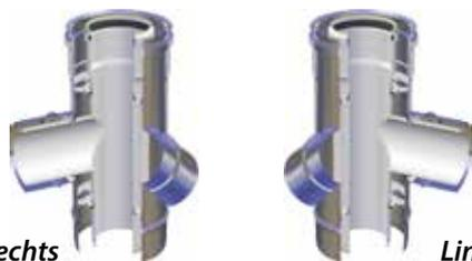
Das abgezeichnete T-Stück 87° ermöglicht den Anschluss des Rauchkanals an das Abzugrohr in einem Winkel von 87°. Dieses Element hat die Besonderheit, die Verbrennungsluft vom Ausstoß der Rauchgase im Rauchkanal zu trennen. Die Ableitung der Verbrennungsluft kann nach rechts oder links vom Kamin erfolgen.
